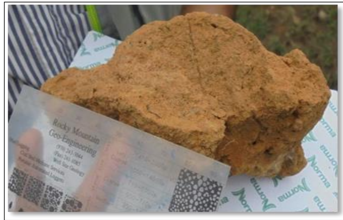
Muestras de suelo residual proveniente de la meteorización del Grupo Real.
